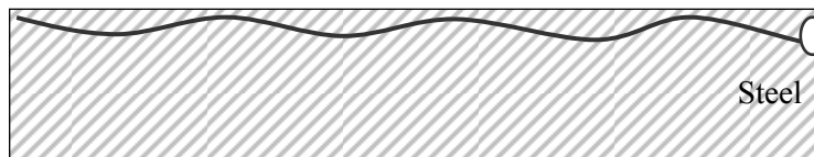
شکل ۱-۴ انتشار امواج سطحی در فولاد
