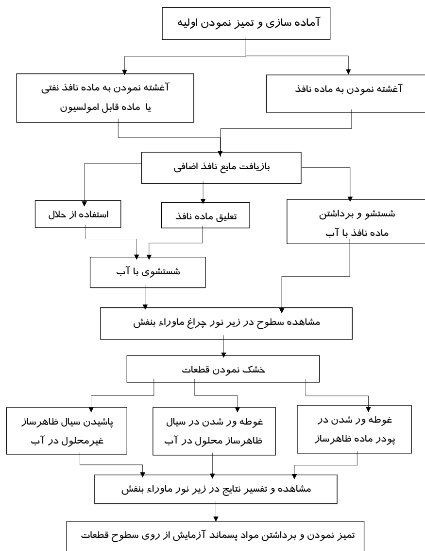
شکل ۵-۲، مراحل آزمایش با ماده نافذ فلورسنتی
